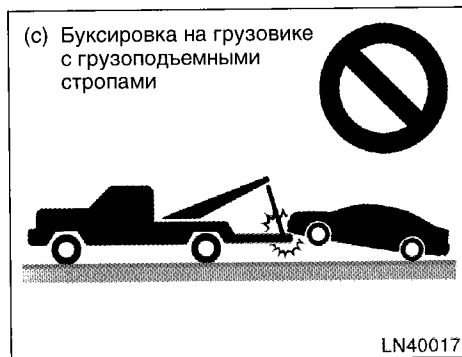
(с) Буксировка на грузовике с грузоподъемными стропами
